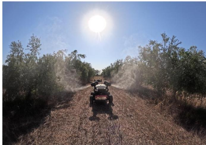
► Nuestro robot terrestre está equipado de dos potentes atomizadores multidireccional 360 grados.
